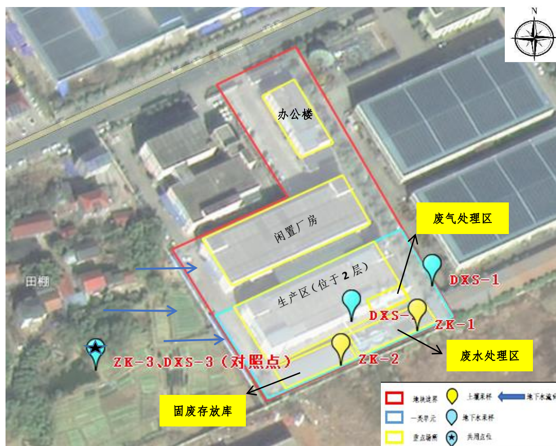
图 6-1 浙江德加电子科技有限公司土壤、地下水布点位置图
